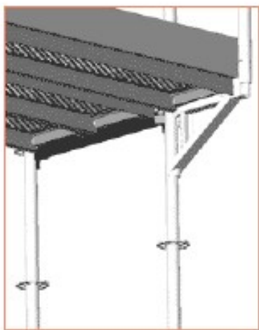
3.27 pav. – Praplatinimas naudojant 0,36 m atramą
