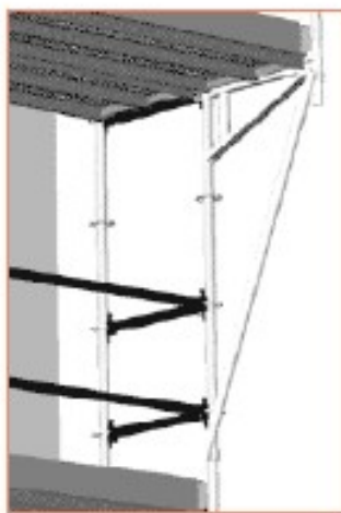
3.28 pav. – Praplatinimas naudojant 0,73 m atramą ir įstrižainę
