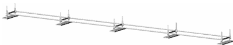
3.54 pav. – 3 etapas – Pradinių elementų susegimas
