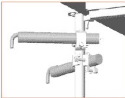
3.31 pav. – Vidinių stovų tvirtinimas V tipo ankeriu
