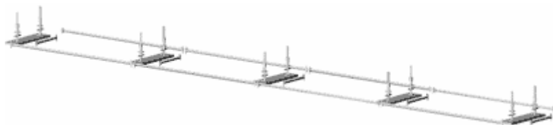
3.53 pav. – 2 etapas – Pradinių elementų uždėjimas
