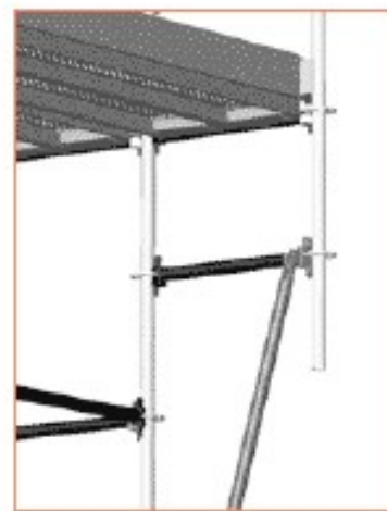
3.29 pav. – Praplatinimas naudojant skersinius ir įstrižaines
