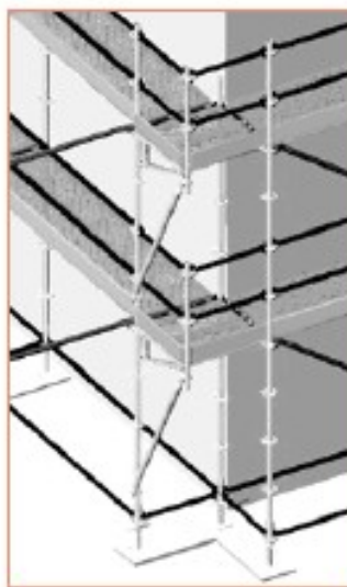
3.25 pav. – Kampas, sudarytas naudojant tris stovus, atramą ir įstrižainę (žr. 3.28 pav.)
