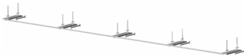
3.52 pav. – 1 etapas – Kojų montavimas
