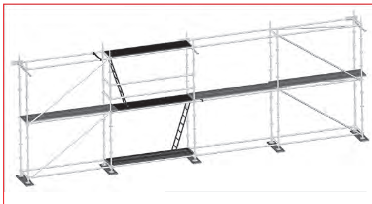
3.59 pav. – Pastolių tvirtinimo ankeriais prie fasado pavyzdys
