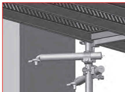
3.31 pav. – Vidinių stovų tvirtinimas V tipo ankeriu
