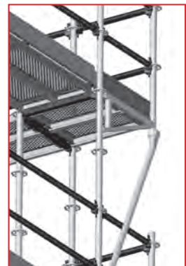
3.25 pav. – Kampas, sudarytas naudojant tris stovus, atramą ir įstrižainę (žr. 3.28 pav.)
