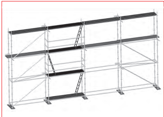
3.61 pav. – Darbinė ir apsauginė aikštelė su įstrižainėmis
