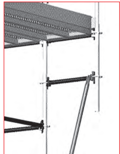
3.29 pav. – Praplatinimas naudojant skersinius ir įstrižaines
