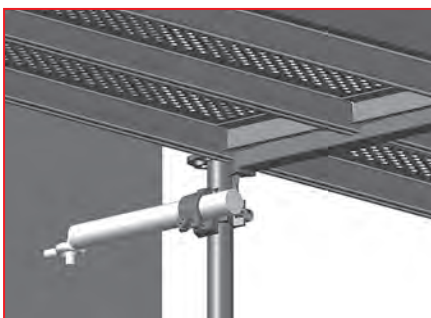
3.30 pav. – Vidinių stovų tvirtinimas viengubu ankeriu
