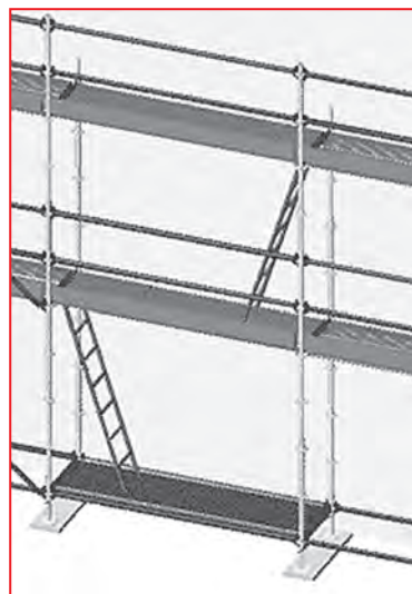
3.41 pav. – Užlipimas ant pastolių naudojant pereinamąsias aliuminines aikšteles su aliuminio kopėčiomis
