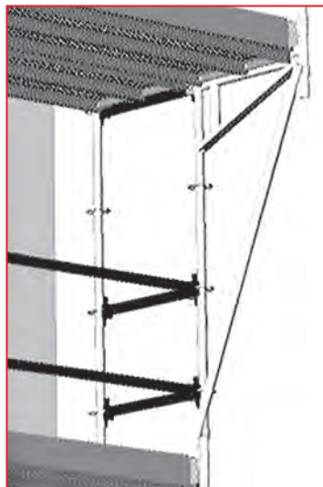
3.28 pav. – Praplatinimas naudojant 0,73 m atramą ir įstrižainę
