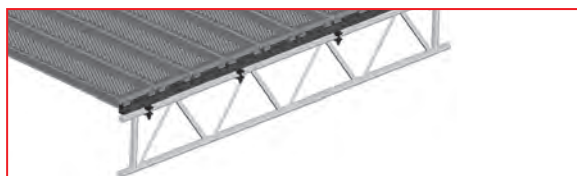
3.37 pav. – Traversos montavimas ant grotuotos sijos.
