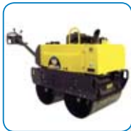
Volai su sudvejintu būgnu gruntui ir asfaltui tankinti
