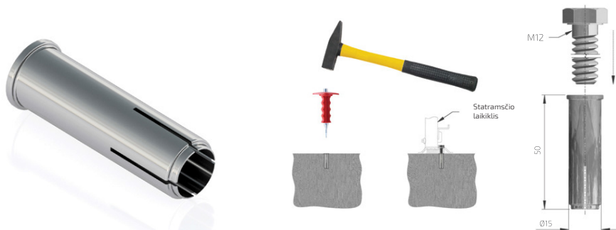
Pav. 31 Fischer EA II M 12 x 50 ankerio ir jo montavimo pavyzdys
